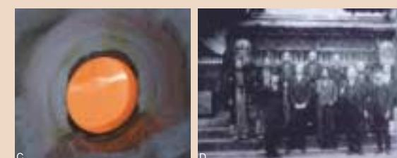
C ガラスを溶かす炉。炉内の温度は1100℃を超える。
